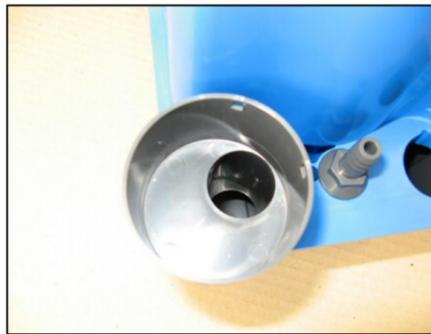
Abb. 2 Zulaufadapter eingesteckt
