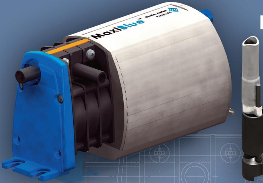
Die Kondensatpumpe MaxiBlue™ ist eine Rotationsmembranpumpe für den Einsatz bei Klima-Split-Anlagen bis zu einer Leistung von 10kW und garantiert Ihnen einen zuverlässigen und störungsfreien Betrieb. Die MaxiBlue™ ist schmal genug für Kabelkanäle, kräftig genug zur Ferninstallation und leise genug zum Zwischendeckeneinbau.
